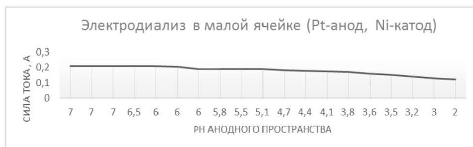
Рисунок 3 – Изменение рН анолита и силы тока при электродиализе
